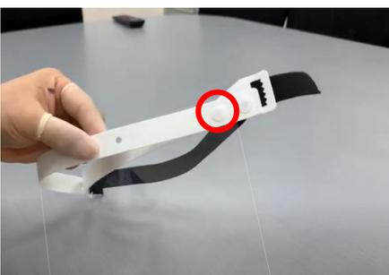
④完成したフレームとシールドを重ね合わせます。端から2番目の穴にシールドを固定します。このとき裏側からフレームA・Bとシールドの3枚を一緒にとめます。
