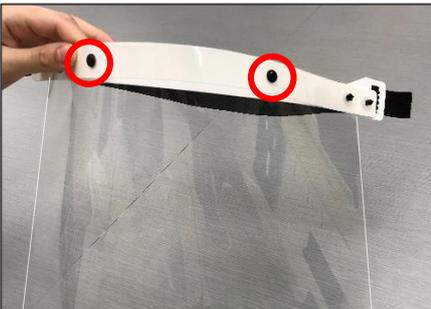
⑤フレームBとシールドを赤丸2箇所穴の内側からクリップを挿し込んでとめます。
