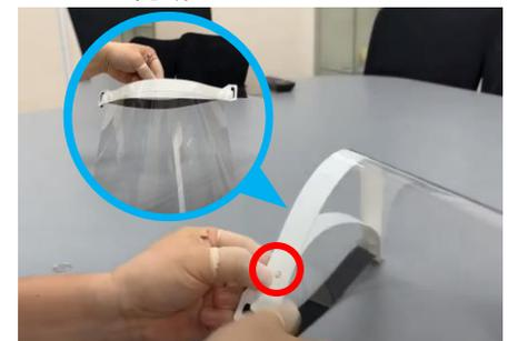
⑥最後に残った穴を裏から3枚まとめて固定すれば、フェイスシールドの組み立て完成です。
