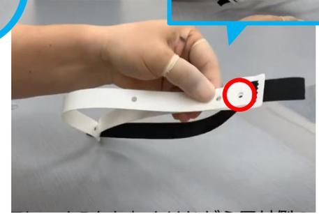
③フレームBをたわませながら反対側の端を②と同じようにクリップでとめます。
